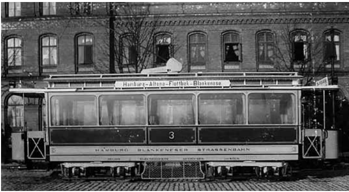
Vierachsiger Triebwagen 3 der „Elektrischen Straßenbahn Hamburg-Blankenese“. [Foto der Wagenbauanstalt Falkenried vermutlich von 1899] Mit solchen vierachsigen Triebwagen wurde Mitte Dezember 1899 der Betrieb aufgenommen. Die Wagenbauanstalt Falkenried hatte die Triebwagen 1899 gebaut.
