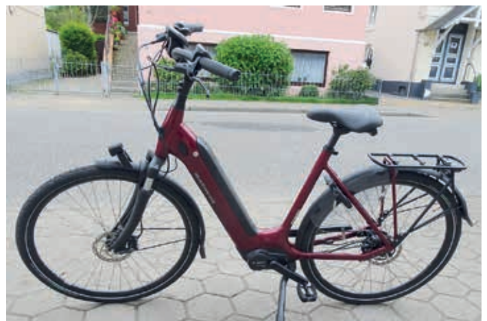
Pedelec mit „wave-Einstieg“ (V-Rahmen) und mit im Rahmen untergebrachtem Akku
